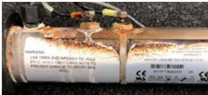
Eroderet varmelegeme med tærede pakninger.
